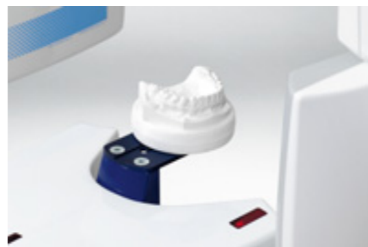
Scansione del calco in gesso per un modello digitale
